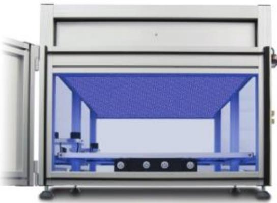
该信息对应于365,385,395,405或450nm的LED的完全拟合。在两种波长的情况下,照射箱的每边配备一个LED类型。
